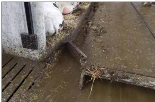
Räumflügel mit einstellbarem Anschlag - Übergang ohne Aufkantung
