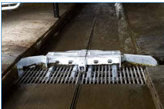
Klapp-Wendeschieber - Umschalten der Klappen nach oben
