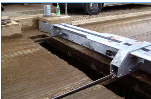
Klapp-Wendeschieber - Umschalten der Klappen nach unten
