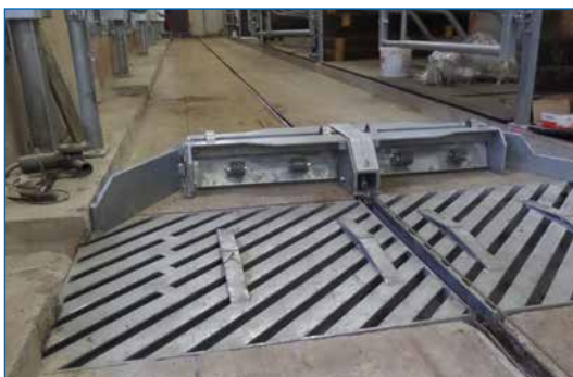
Klapp-Wendeschieber - Umschalten der Klappen nach oben
