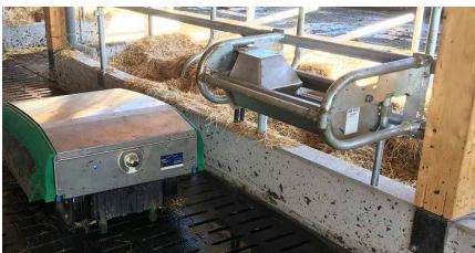
Durch den fast bündigen Wannenboden mit der kompakten Wand-Konsole, ist die Tränke mit den Robotern unterfahrbar.
