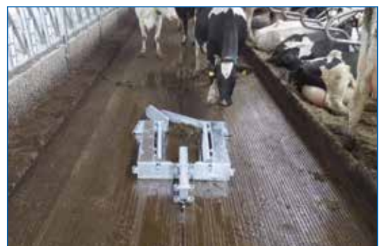
Klappschieber zusammengefallen - überfahrbar
