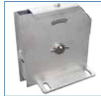
Stehende Umlenkstation für Wand- oder bodenbefestigung , mit kugelgelagerter Seilrolle Ø 250 mm (Best.-Nr. 121.0493) Ø 350 mm (Best.-Nr. 121.0501)
