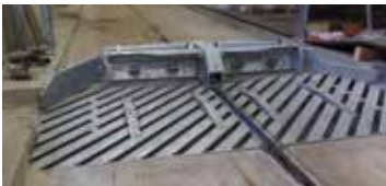
Umschalten der Räumklappen nach oben
